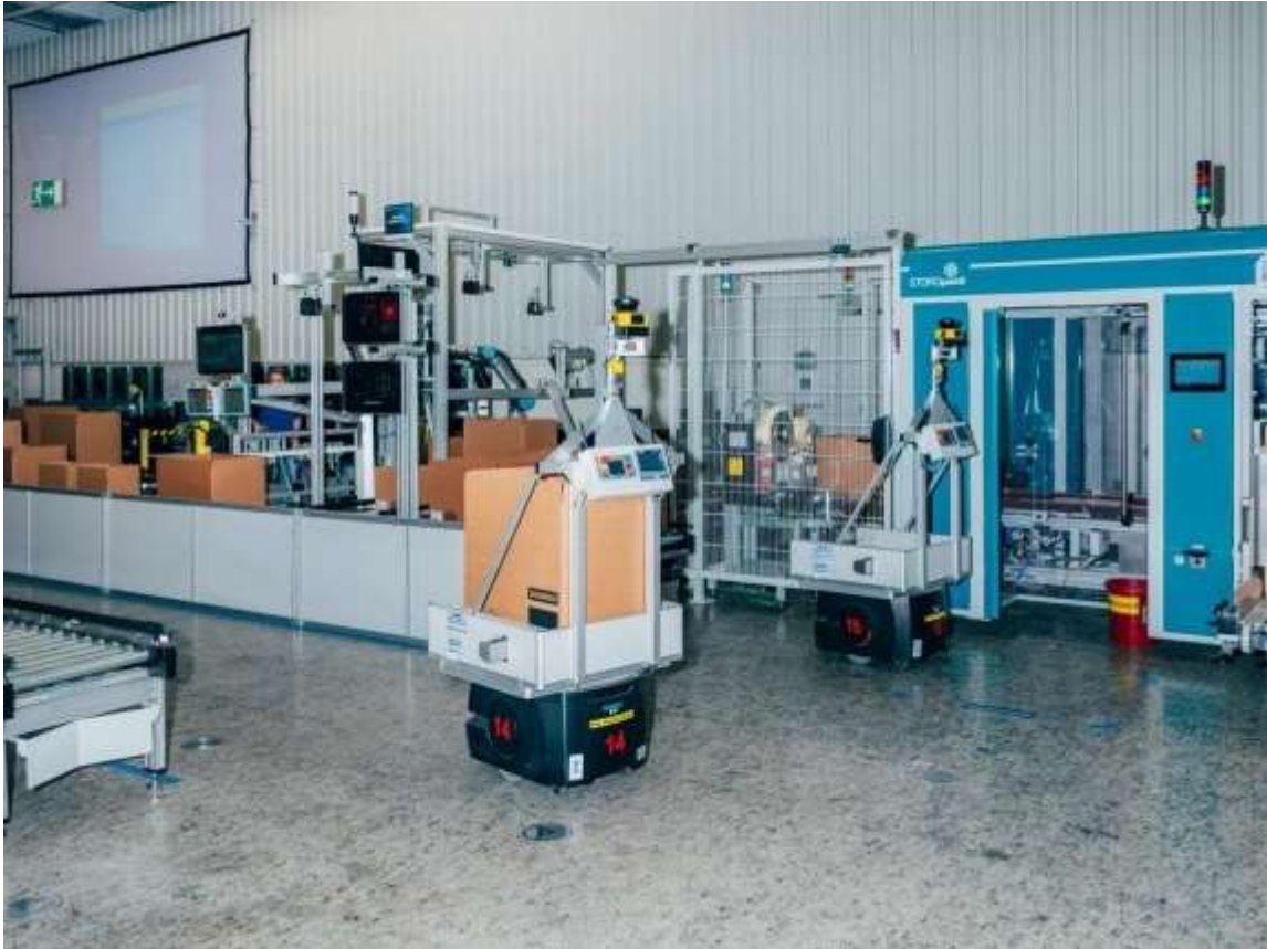
Uno dei robot che nella fabbrica Siemens ad Erlangen, si muovono in autonomia in giro per l'impianto trasportando carichi (Fonte: Siemens)
