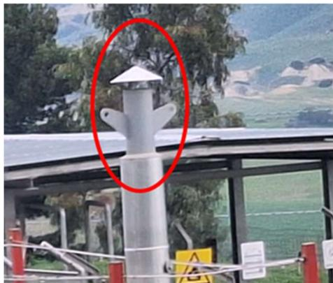
Il primo elemento preso in considerazione era il tubo di sfiato evidenziato nell'immagine, posto a circa 40 metri di distanza dallo strumento e monitorato per 4 minuti in presenza di un vento moderato, e dove sono stati rilevati valori tra 100 a 1.258 ppm\*m, facendo registrare una media di 253 ppm\*m. Qui sono stati 155 i punti di misura validi.
